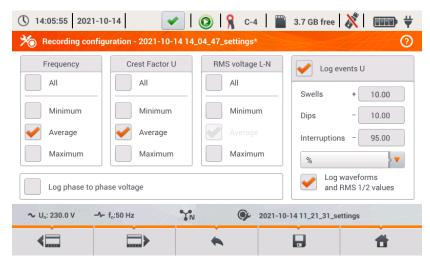
Fig. 8. Recording configuration - Voltage parameters
